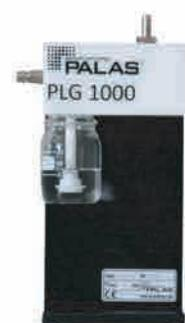
油雾气溶胶发生器，用在过滤器测试台上
