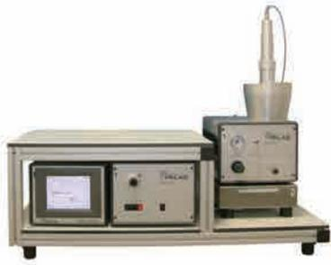
通过粉末、粉尘、花粉等生成测试气溶胶；质量流速约 8 g/h - 7.3 kg/h，自动监测质量流速
