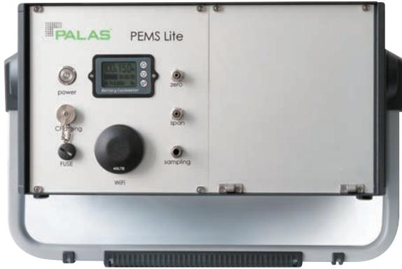
该系统是一款专门用于车辆及发动机烟气分析的便携式分析系统设备，主要分析气体污染物如  $\text{NO}_x/\text{O}_2/\text{CO}/\text{CO}_2/\text{HC}$ ，环境参数仪采集环境温度、湿度、气压，OBD 采集车辆参数，GPS 采集经度、纬度、位置信息等，也可选配流量分析系统。
