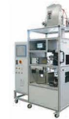
模块化过滤介质测试台，用于测试抽吸模式下的分数效率、差压、容尘量和重量效率。HF型带有温度和湿度控制功能。
