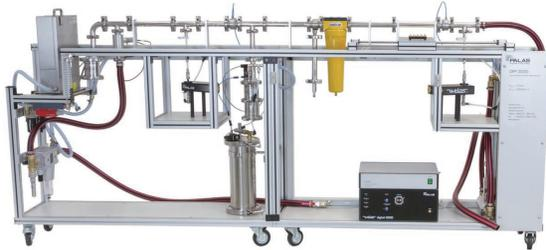
DFP 3000 压缩空气过滤器测试台
