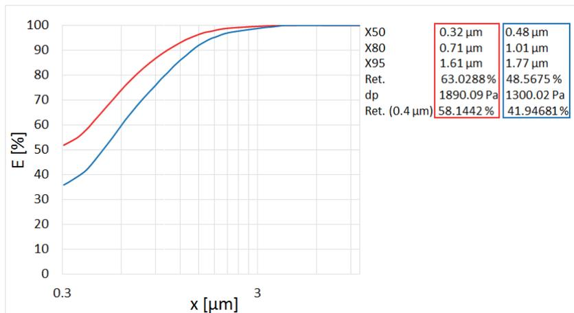
图3:不同的油雾分离器的过滤效率比较
