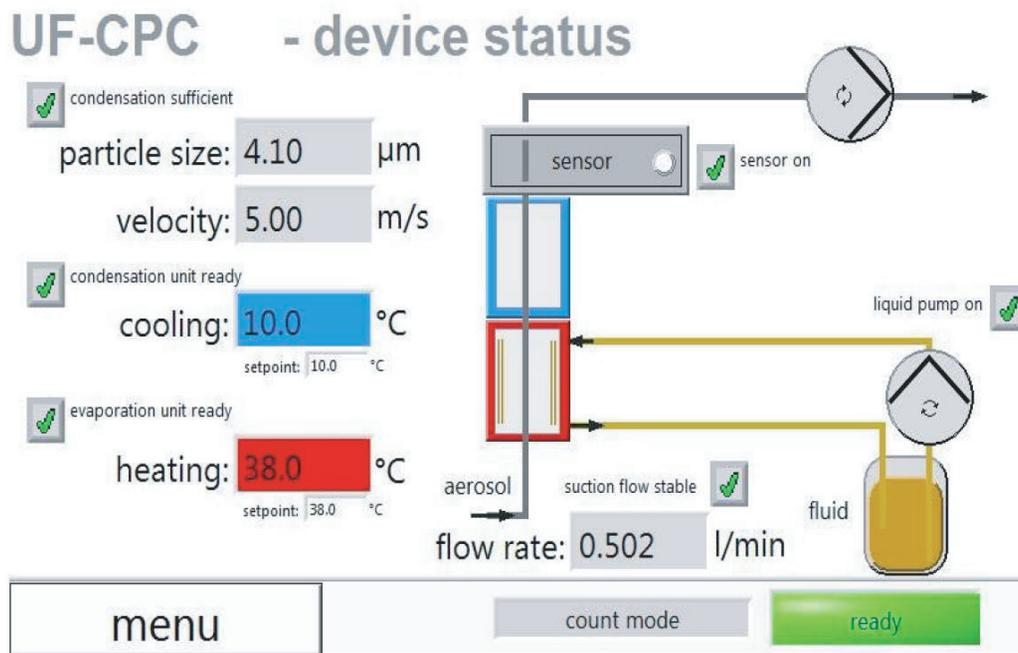
图2: 触摸屏用户界面 (显示设备状态)
