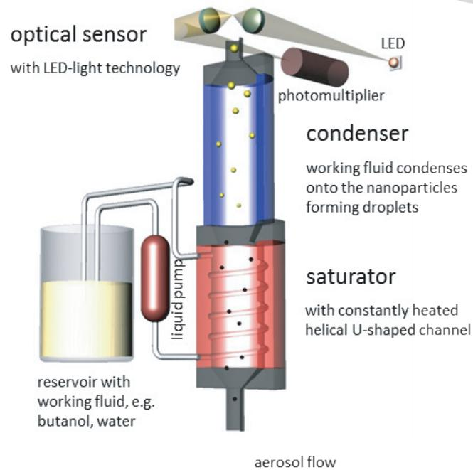
图1: 冷凝粒子计数器 (UF-CPC) 的工作原理
