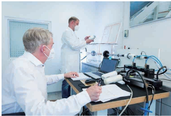
图 1: 透过率测试台 TÜV NORD (测量腔和 Palas 光度计 Welas®)
