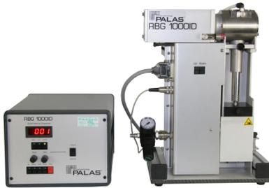
Dispergiereinheit und Steuereinheit getrennt, druckfest bis 3 bar Überdruck, optionaler Unterdruckbetrieb ab 300 mbar (Absolutdruck)
